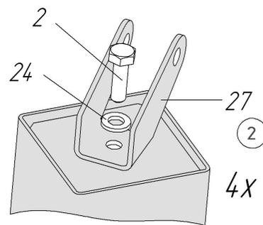
**4.** Установите стяжки поперечные на обе стороны используя болты (2) и шайбы (24). Получатся две стойки в сборе.
