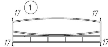
**3.** Соедините стойку 1 (заднюю правую) и стойку 2 (переднюю правую) с помощью боковины и болтов (3) с шайбами (24). Боковину расположите отверстием под стяжку заднюю (опорную) назад.
