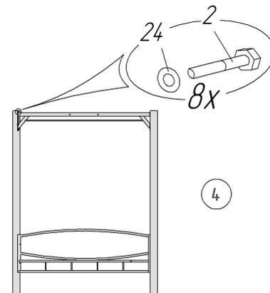
**5.** Соедините две стойки в сборе с помощью задней части, используя болты (2) и шайбы (24).
