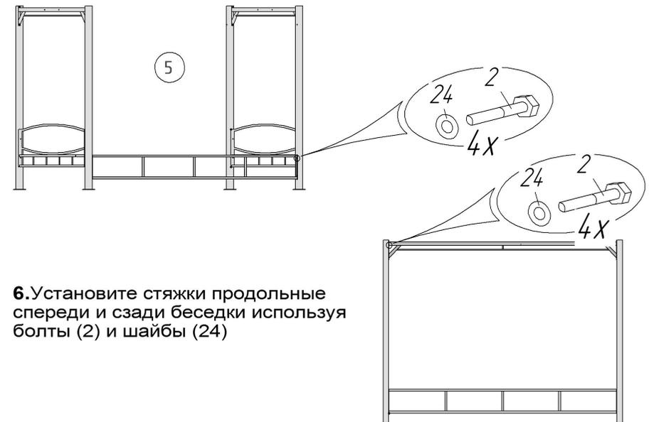
**6.** Установите стяжки продольные спереди и сзади беседки используя болты (2) и шайбы (24)
