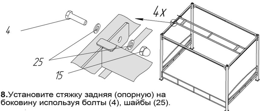
**8.** Установите стяжку задняя (опорную) на боковину используя болты (4), шайбы (25).
